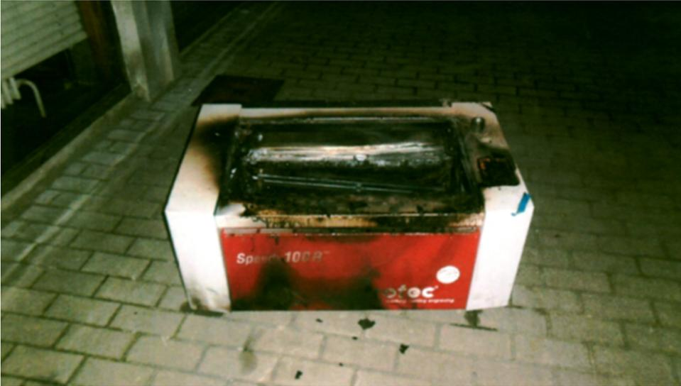
Bild: Ein ausgebrannter Lasercutter des FabLab Leuven. Der Benutzer meinte, weil die Datei dreimal funktioniert hat, müsse man beim vierten mal nicht mehr dabeibleiben.
